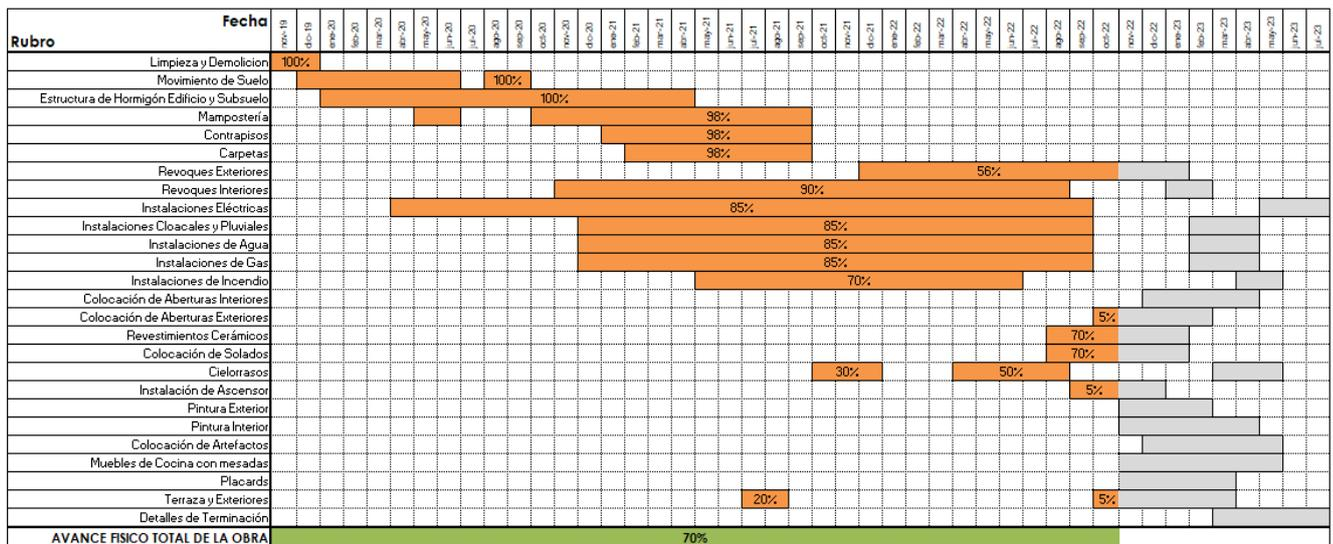
Como complemento del gráfico de avance de obra, les informamos que durante el mes de diciembre se culminarán los trabajos de revoque exterior proyectados para frente y contrafrente. Además, realizaremos la colocación de aberturas exteriores en frente y contrafrentes, y el ajuste de puertas principales e interiores.
